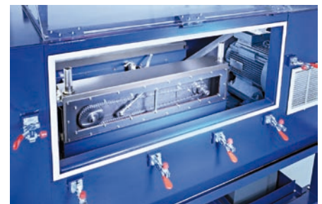
Untersuchung des Verschleißverhaltens auf mehr als 20 Prüfständen Testing of chain wear elongation behaviour on more than 20 test rigs
